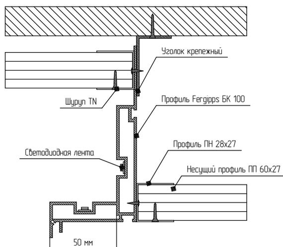
2. Установите каркас нижнего и верхнего уровня с учётом количества слоёв и толщины гипсокартона. Если нужно, установите и подключите светодиодную ленту.
