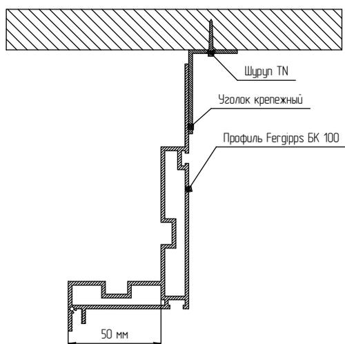
1. Сделайте отметку перехода уровня на основном потолке, затем сдвиньте отметку на 65 мм вглубь предполагаемого нижнего уровня – в этом месте будут стоять уголки. Установите БК 100 на уголки к основному потолку.
